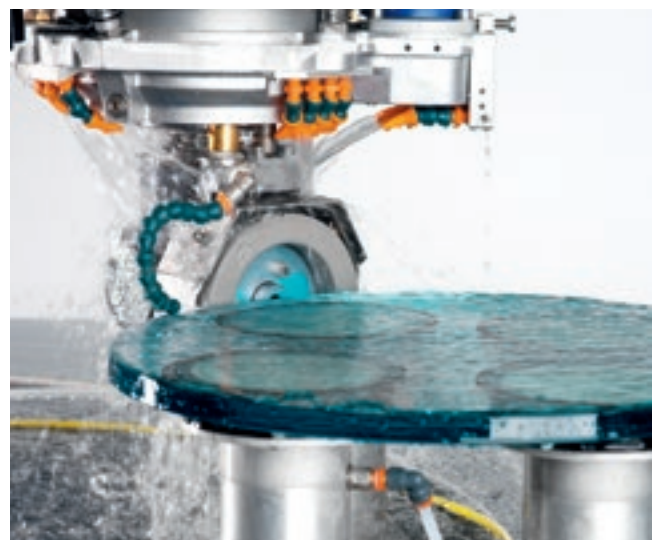
Desbaste e polimento tipo copo com agregado.
