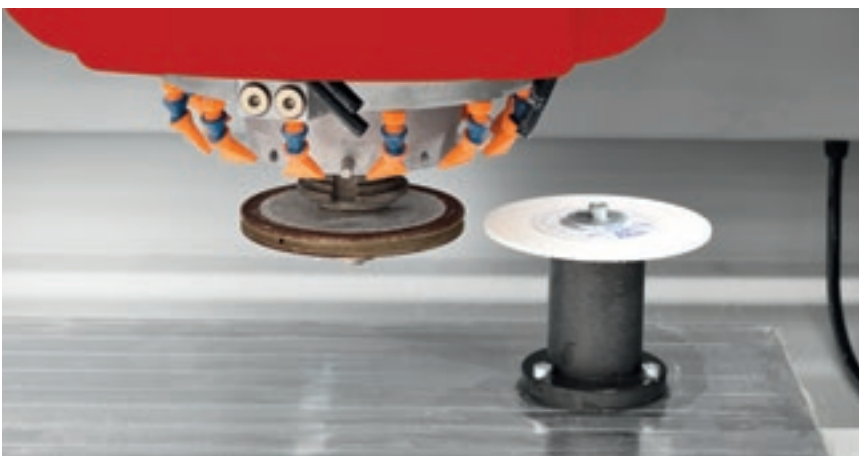
Retificador dos rebolos diamantados.
